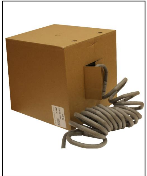
Bunnlist brukes som underlag ved fugging, for å sikre korrekt dimensjonering og at fugemassen ikke setter seg fast i bunnen av fugen.
